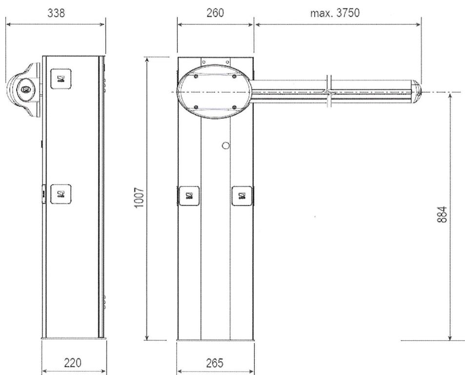
1.4. Технические характеристики ограждающего устройства:
